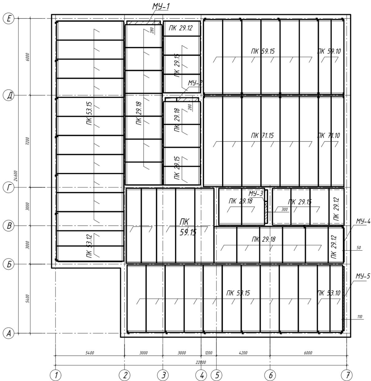
Спецификация элементов перекрытия
